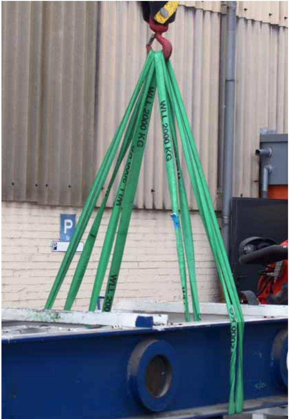
**!** DoStabil Rundschlingen mit PU-Imprägnierung sind optimal für den Einsatz in U-Form. Schnürgang möglichst vermeiden!
