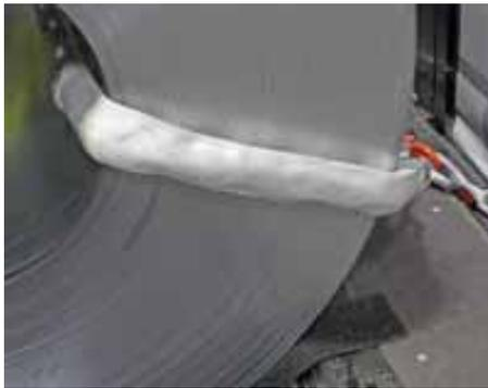
**Kantenschutzschläuche aus Dyneema®** bieten Rundschlingen und Hebebändern optimalen Schutz gegen scharfe Kanten. Die Lebensdauer der textilen Anschlagmittel wird deutlich verlängert bzw. ermöglicht überhaupt erst die Verwendung von textilen Anschlagmitteln bei bestimmten scharfkantigen Lasten.
