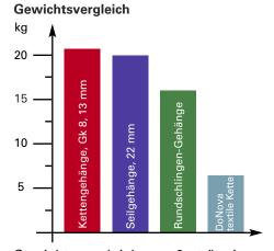
Gewichtsvergleich von 2-strängigen Anschlaggehängen mit 2 m Nutzlänge bei gleicher WLL von 7500 kg
