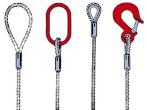
Endverbindungsvarianten für Zurrdrahtseile
