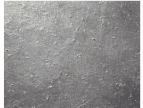
Abb. 2: Schwerlast ARM, massiv, vulkanisiert, ohne Hohlraumanteil
