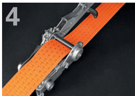
4 Seitenteil schließen Nachdem das Gurtband eingelegt ist, muss das Seitenteil wieder geschlossen werden.
