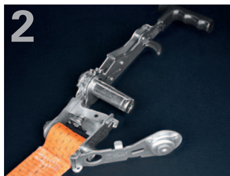
2 Ratsche öffnen, Verriegelung lösen Durch das Öffnen der Ratsche (Handhebel in die Auslöse-Stellung bringen) löst sich die Verriegelung der Gurtbandzuführung. Das Seitenteil lässt sich öffnen.
